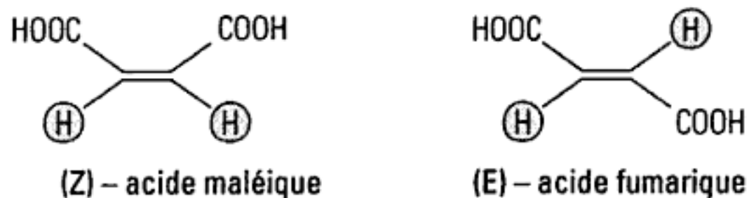
Fig. 3 – Stéréoisomérisie géométrique Z/E.
